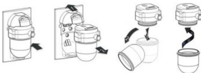
Obrázek 1.6 – Vyprázdnění odlučovače vody.
