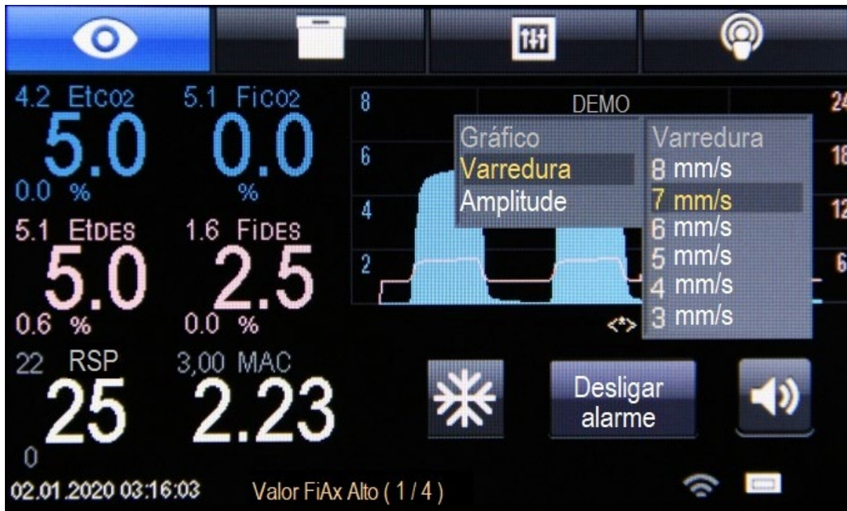
Figura 1.14 - Menu de gráfico, Velocidade de varredura
