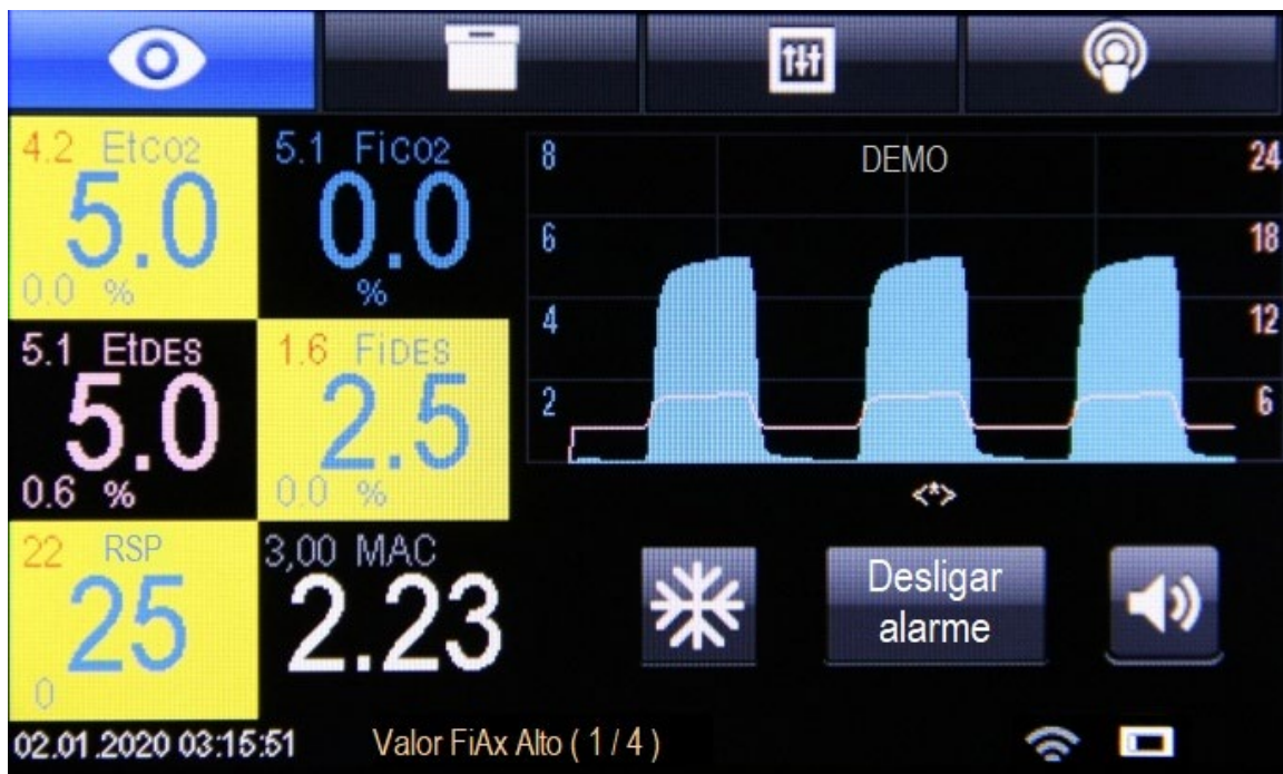
Figura 1.11 - Tela “Monitoring” (Monitoramento) (tela padrão sem FiCO 2 , FiAx)
