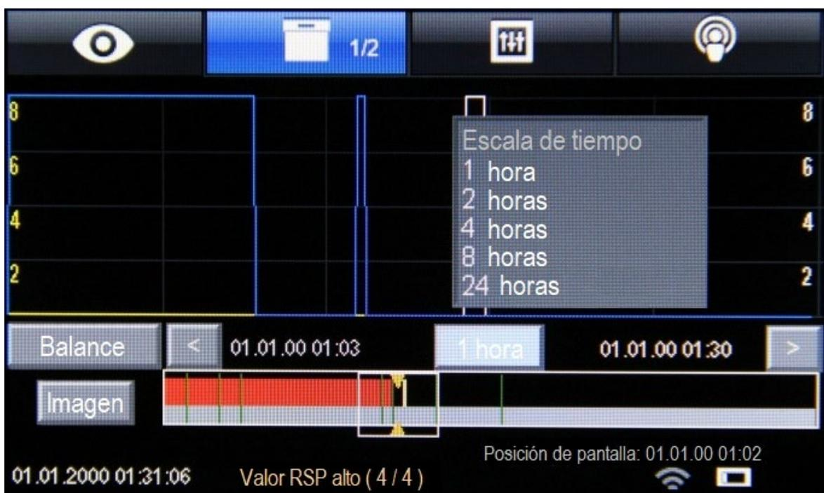
Imagen 1.21 - Panel de navegación, Configuración de longitud de zona de desplazamiento
