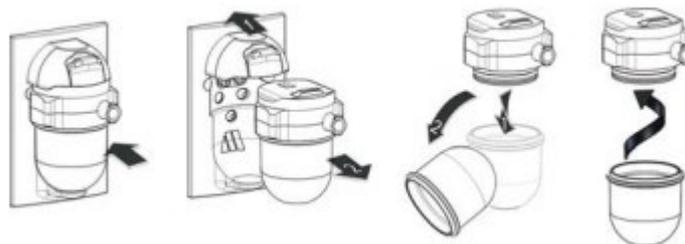
Imagen 1.6 - Vaciar el colector de agua
