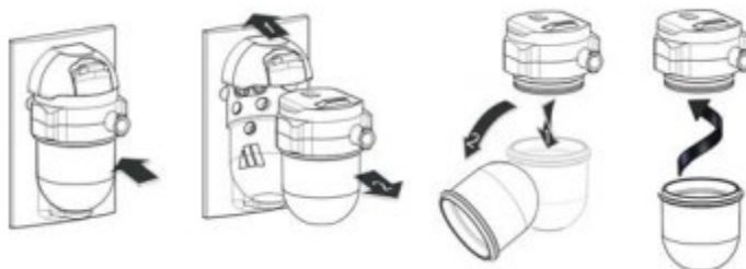
Figure 1.6 – Vidage d'un piège à eau
