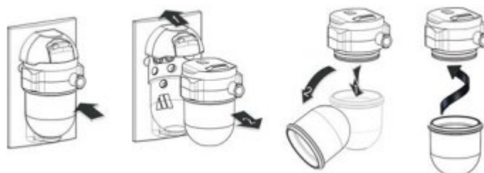
Figura 1.6 – Svuotamento del separatore di condensa
